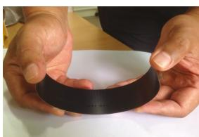
La imagen superior muestra la condición física de los cojinetes de lámina de aire después de 100,000 veces de pruebas de encendido/apagado.
