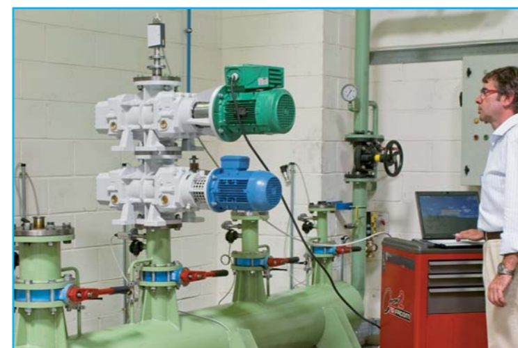
El acoplamiento magnético en el banco de pruebas, en las instalaciones PG. / Magnetic coupling on the testing bench at PG's facilities.
